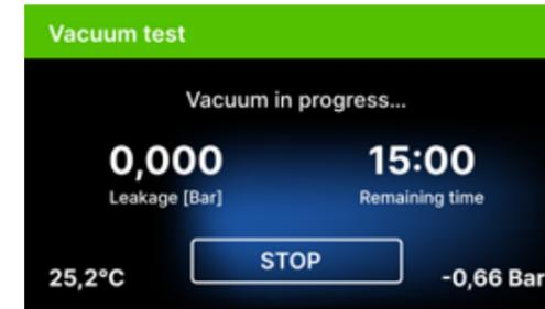
Nach der Auswahl eines Vakuumprüfprogramms und dessen Start mit der Taste wird der Bildschirm für den Ablauf des Vakuumprüfprogramms angezeigt, mit Informationen über den Druckverlust in der Arbeitskammer und die Dauer der Prüfung.
