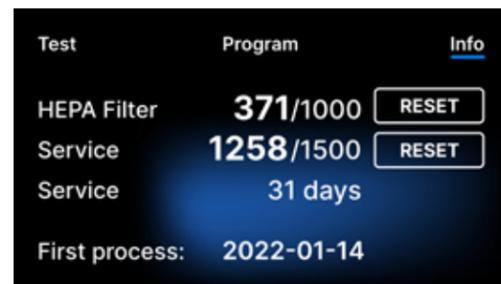
Während des ersten Prozesses (Vakuum, Helix, FAST, 134, 121) speichert das Gerät das aktuelle Datum als das Datum des ersten Prozesses (untere Zeile auf dem Zählerbildschirm). Das Gerät zählt die Vorgänge und Tage seit dem ersten Einschalten.
