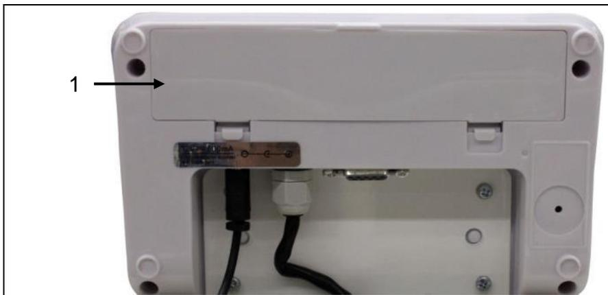
Akkufachdeckel (1) an der Unterseite des Anzeigergerätes öffnen und Akku anschließen. Der Akku sollte vor der ersten Benutzung mindestens 12 Stunden geladen werden.
