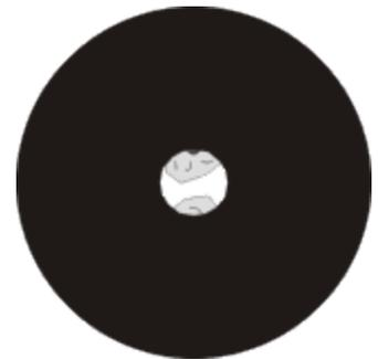
5. Leuchtfeldblende so weit öffnen, bis sie gerade aus dem Sehfeld verschwindet. Wenn notwendig mit den Zentrierschrauben des Kondensorträgers leicht nachzentrieren.
