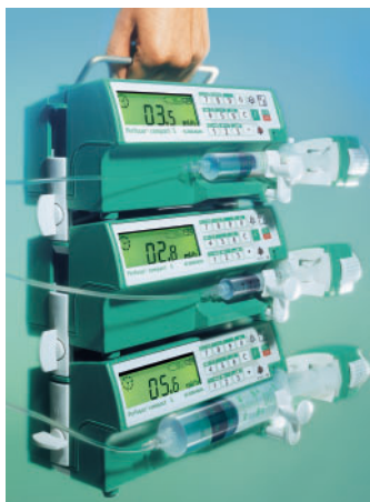
Perfusor® compact S – stapelbar und verriegelbar zu mobilen Therapieeinheiten.
