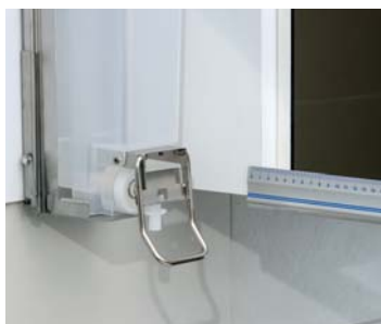
Achten Sie beim Einbau von verborgenen Produkten darauf, dass ein Abstand von mindestens 10 mm vom Spender zum Spiegel eingehalten wird.
