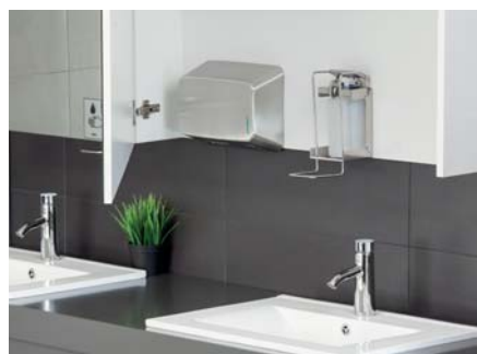
Ansicht bei geöffneter Spiegelfront: Der Spender ist hier zur Befüllung und Revision frei zugänglich.
