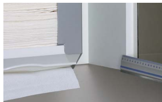
Beim Einbau sollte stets ein Revisionsabstand von mindestens 10 mm vom Spender bis zur Spiegelfläche eingeplant werden.
