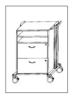
2 Röntgentaschenablagen, 2 Karteiauszüge DIN A4 abschließbar, 1 Schiebegriff. Mit integrierter Gewichtsplatte als Kippschutz.
