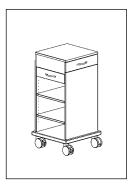
Grundwagen in Sondermaß mit 1 seitlichem Schiebegriff, Laptopfach seitlich ausziehbar, Halter für Kensingtonschloss, 1 Schublade und 2 Fachböden. Rollen Ø 100 mm, 2 Rollen feststellbar.
