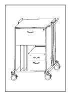
Karteiauszug DIN A4 abschließbar, Fachboden, darunter Einsatz für Röntgentaschen mit senkrechter Unterteilung. Zwischenwand für Ablagefach, darunter Fachboden schmal, 2 schmale Schubladen 100 und 200 mm hoch, 1 Schiebegriff.
