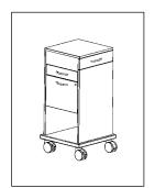
Grundwagen in Sondermaß mit 1 seitlichem Schiebegriff, seitliches Laptopfach ausziehbar, Halter für Kensingtonschloss, 1 Schublade 100 mm hoch, 1 Karteiauszug DIN A4, abschließbar. Rollen Ø 100 mm, 2 Rollen feststellbar.
