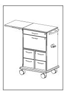
inkl. 1 Schublade 100 mm, 1 Karteiauszug DIN A4, jeweils abschließbar, 4 kleine Schubladen 200 mm hoch ,1 Ablageplatte seitlich klappbar, 2 Kunststoffhaken seitlich am Wagen, 1 Schiebegriff. Rollen Ø 100 mm, 2 Rollen feststellbar,
