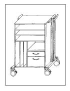
3 Röntgentaschenablagen, 1 Fachboden schmal, 1 schmale Schublade 100 mm, 1 schmale Schublade 200 mm, Einsatz für Röntgentaschen mit senkrechter Unterteilung, 1 Schiebegriff.
