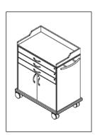
inkl. Galerieaufsatz, 3 abschließbare Schubladen, 100 mm hoch, 2 Türen mit 2 Einlegeböden, 1 Schiebegriff. Rollen Ø 100 mm, 2 Rollen feststellbar.
