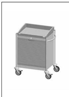
ABS-Kunststoffarbeitsplatte mit 4-seitiger Aufkantung, aluminiumfarbener Rollladen mit Schloss und Griff, 2 ISO-Modulträgerwände für 4 ISO-Module, 100 - 110 mm,
