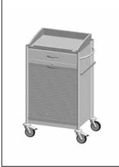
ABS-Kunststoffarbeitsplatte mit 4-seitiger Aufkantung, aluminiumfarbener Rollladen mit Schloss und Griff, 2 ISO-Modulträgerwände für 5 ISO-Module, 100 - 110 mm, 1 Schublade 125, 1 Normprofilschiene aus Edelstahl.
