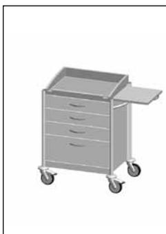
ABS-Kunststoffarbeitsplatte mit 4-seitiger Aufkantung und seitlichem Auszug, Metall. Einlegeplatte aus Edelstahl, 3 Modul-Vollauszüge (110%) zur Aufnahme von ISO-Modulen 50 oder 100 mm hoch. 1 Modul-Vollauszug (110%) zur Aufnahme von ISO-Modulen 200 mm hoch,
