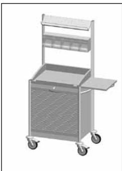
Organisationssystem mit 1 geneigten Ablageebene und 5 Klemmen, Kanülenspender PicBox® mit 5 kleinen Schütten. ABS-Kunststoff Arbeitsplatte mit 4-seitiger Aufkantung und seitlichem Auszug, aluminiumfarbener Rollladen mit Schloss und Griff, 2 ISO-Modulträgerwände für 4 ISO-Module, 100 - 110 mm,
