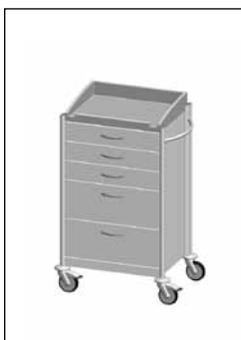
ABS-Kunststoffarbeitsplatte mit 4-seitiger Aufkantung, Einlegeplatte aus Edelstahl, 3 Modul-Vollauszüge (110%) zur Aufnahme von ISO-Modulen 50 oder 100 mm hoch. 2 Modul-Vollauszüge (110%) zur Aufnahme von ISO-Modulen 200 mm hoch,
