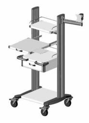
mit 2 Platten 485 mm tief, 1 Ablageplatte 300 mm tief, 1 Auszugsplatte für Keyboard inkl. Mousepad, ausziehbar, 1 Schublade, 2 Schubladengriffe, 2 Relings, 1 horizontale Kabelkanaltraverse, 1 "alegro" Monitorhalter auf Gelenkarm mit integrierter Kabelführung (Traglast bis 12 kg).
